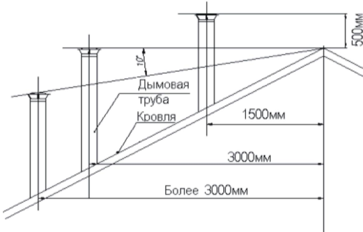
Рис.4. Определение высоты наружной части дымовой трубы
