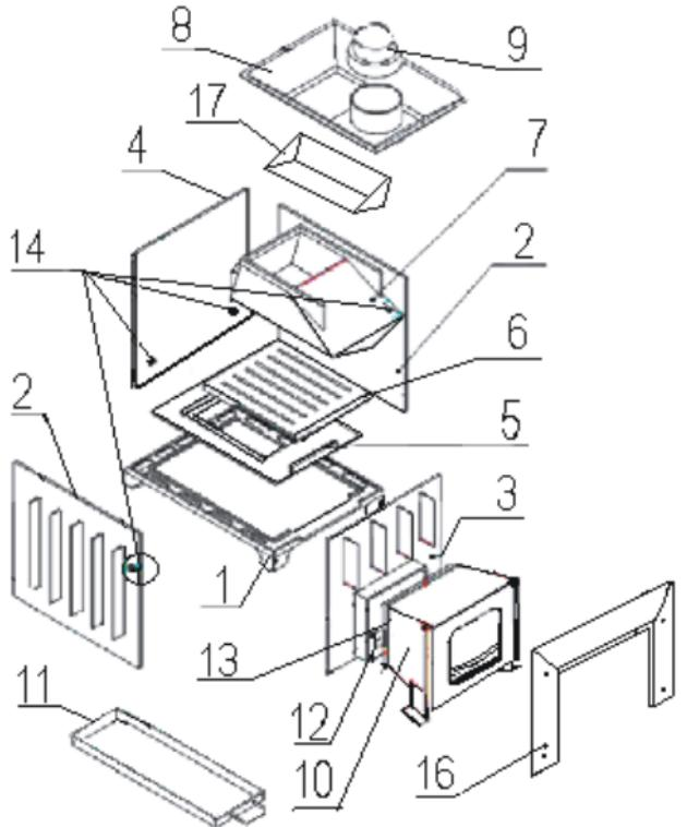
Рис.1. Сборка чугунного топочного агрегата
