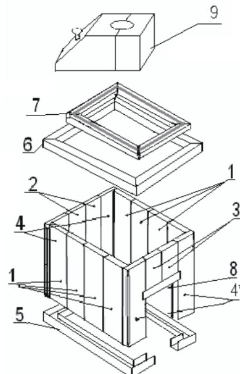
Рис. 2. Установка облицовки из Т/Х или камня «Змеевик»
