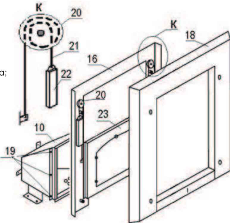
Рис. 1а. Сборка механизма лифтовой дверки
